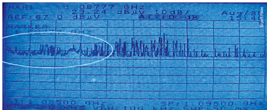
Tela do analisador de espectro com sinal interferente (em destaque à esquerda) e sinais de transponders
